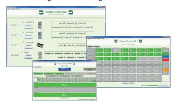
Mit CERES CONTROL programmieren, steuern und überwachen Sie DLI-Z64 Einzelbatterieanlagen und LPS LowPower Systeme.
