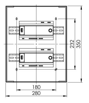
Höhe des Gehäuses inclusive Deckel 100mm
