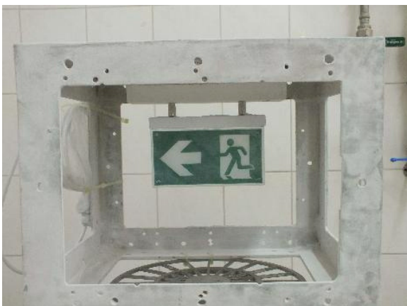
Bild 5 Ceruna (Rettungszeichen und Sicherheitsleuchte) auf dem Drehteller montiert vor der Spritzwasserschutzprüfung IPX4
