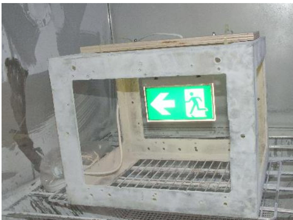
Bild 3 Ceruna (Rettungszeichen und Sicherheitsleuchte) montiert in der SK89 vor der Fremdkörperschutzprüfung IP5X
