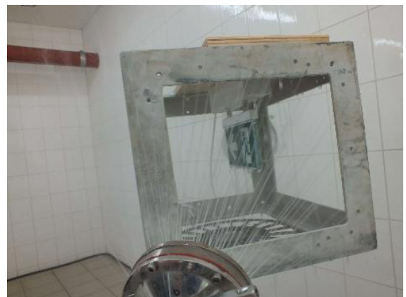
Bild 6 Ceruna (Rettungszeichen und Sicherheitsleuchte) mit genormter Spritzbrause bei der Spritzwasserschutzprüfung IPX4
