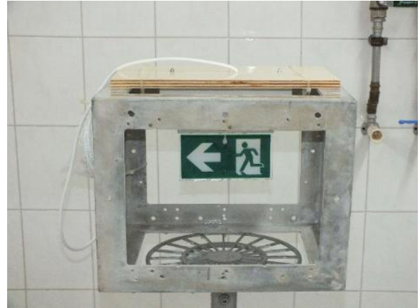
Bild 8 Ceruna (Rettungszeichen und Sicherheitsleuchte) auf dem Drehteller montiert nach der Spritzwasserschutzprüfung IPX4
