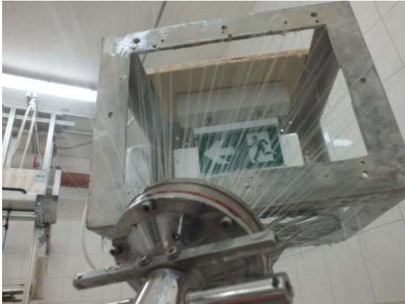
Bild 7 Ceruna (Rettungszeichen und Sicherheitsleuchte) mit genommener Spritzbrause bei der Spritzwasserschutzprüfung IPX4
