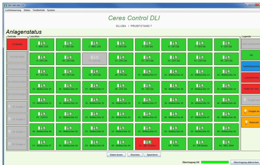
In der linken Spalte wird der Status der DLI-Z64 angezeigt. Bei entsprechendem Zustand wird das zugehörige Feld aktiviert.
