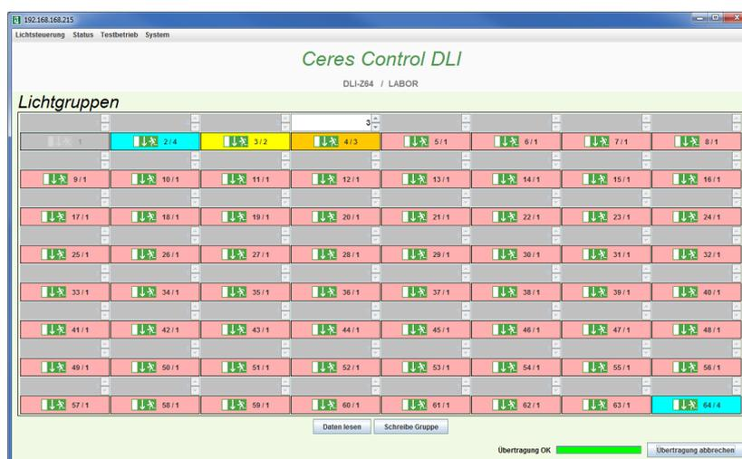
Haben Sie zuvor Bezeichnungen für Leuchten eingetragen oder aus der DLI-Z64 ausgelesen, werden diese über Tool-Tipps angezeigt, sobald sie die Maus über eine Leuchte halten.
