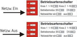
Netzw. aus = Netzüberwachung aus
